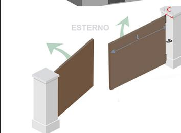
Se il cancello apre verso l'esterno della proprietà (vedi pag.9) Verificare l'ingombro del motore e seguire lo schema di fissaggio rispettando i limiti di misura A e B qui sotto riportati.
