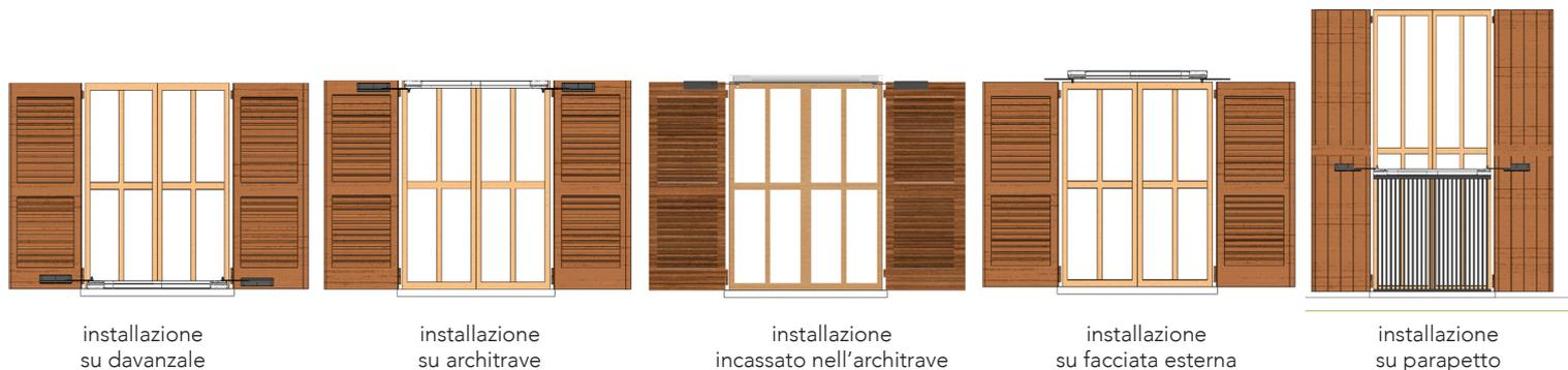
E anche possibile effettuare l'installazione su architrave incassando parzialmente la motorizzazione nell'architrave. La motorizzazione va installata nello spazio disponibile tra persiana chiusa e serramento interno (finestra/ zanzariera/ grata fissa).
